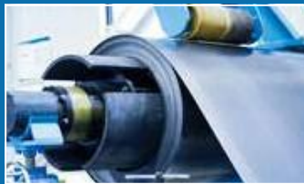
Линия лазерной резки Разматывание-выравнивание-резка. Серийная обработка листового рулонного металла
